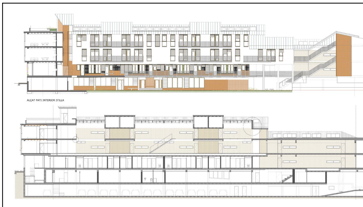
Alçat i secció longitudinal - pati interior
